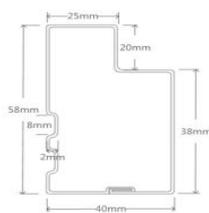
4、床中短横梁：采用优质冷轧钢板经特制线型轧制成型，梅花型（异形管）高频焊接闭合管有效避免展开，规格： $\geq 75\text{mm} \times 39\text{mm} \times 1.0\text{mm}$ 厚，管材前后面需设计各2条内凹加强筋，2条加强筋之间成半圆弧形，增加承重能力。床中短横梁管材截面参照图：
