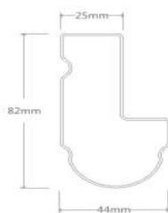
3、床两侧上短横梁：采用优质冷轧钢板经特制线型轧制成型，L形闭合管有效避免上短横梁展开，规格： $\geq 40\text{mm} \times 58\text{mm} \times 1.0\text{mm}$ 厚，管材顶端为  $25 \pm 2\text{mm}$ ，上短横梁下沿反抱式咬牙连接。
