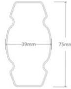
5、爬梯：支架采用优质冷轧钢管，规格： $\geq 20\text{mm} \times 40\text{mm} \times 1.2\text{mm}$ 厚椭圆管弯制成型，爬梯踏板：采用优质冷轧钢板一次冲压成马鞍型，尺寸： $372\text{mm} \times 107\text{mm} \times$ 宽85mm（允许公差 $\pm 5\text{mm}$ ） $\geq 1.5\text{mm}$ 厚，踏板表面设计防滑装置：左右各设计一块塑料防滑垫并且具有夜视功能，方便上下床铺，防滑垫规格： $110\text{mm} \times 58\text{mm}$ （允许公差 $\pm 5\text{mm}$ ），中间设计一个塑料指引箭头具有夜视功能，学生；踏板底部设计 $20\text{mm} \times 30\text{mm}$ （允许公差 $\pm 2\text{mm}$ ）方管加固。
