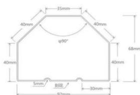
2、床横梁：采用优质冷轧钢板经特制线型轧制成型，P形高频焊接闭合管有效避免床横梁展开，规格： $\geq 82\text{mm} \times 44\text{mm} \times 1.2\text{mm}$ 厚，床横梁顶端为  $25 \pm 2\text{mm}$ ，侧面成型后预留  $\geq 40\text{mm}$ 承托床板，床横梁底部成半圆弧形防止学生碰头，钢管正面带花纹设计，人体接触面设计2条内凹加强筋，以起到床横梁的承重强度。床横梁管材截面参照图：
